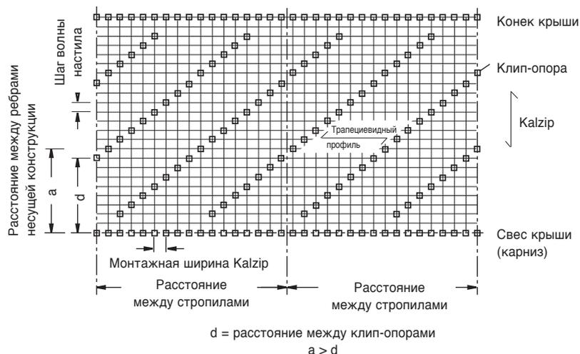
**Схема укладки 2**
