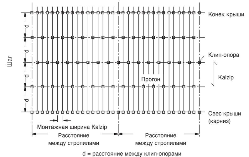
**Схема укладки кровельной конструкции DuoPlus 100**
