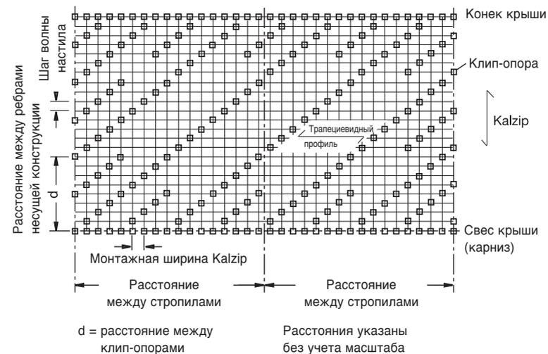
**Схема укладки кровельной конструкции DuoPlus**
