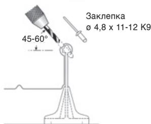
Положение точек фиксации определяется статическим расчетом и указывается в плане укладки.
