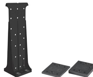
Новым поколением клип-опор Kalzip, предназначенных для крепления профилированных листов Kalzip, является опора типа E, которая минимизирует теплопотери за счет ликвидации мостиков холода и позволяет изготавливать кровли с высокими теплозащитными характеристиками. Клип-опора Kalzip типа E состоит из стальной основы и оболочки из полимерного материала, армированного стекловолокном.
