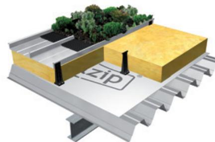
На каждую из уже описанных кровельных конструкций – при выполнении требований статики и при применении Kalzip 65/333 – можно дополнительно уложить «зеленую кровлю» Kalzip NaturDach.
